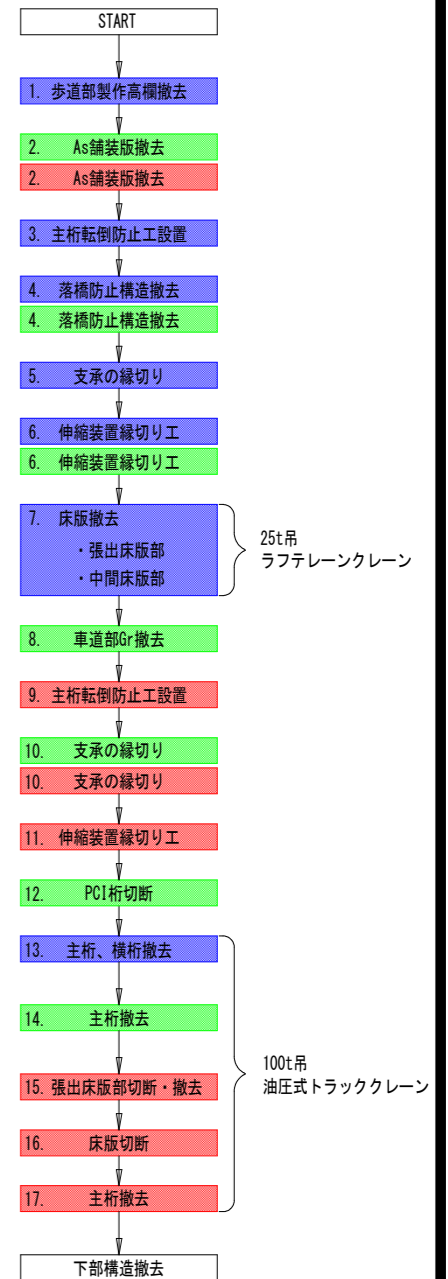
上部構造撤去フロー
